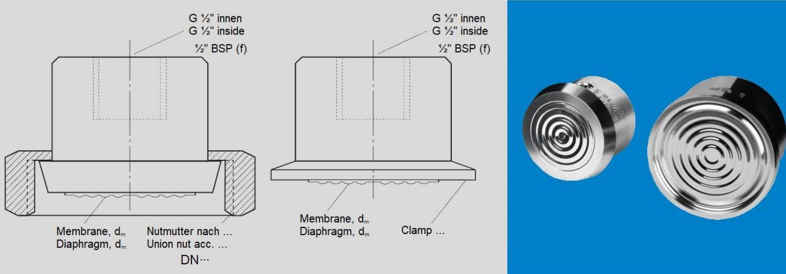
**Tri-Clamp, für Rohre nach BS 4825 und O.D.-Tube; ASME BPE und ISO 1127**
