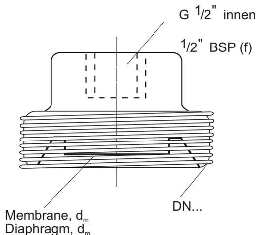
**Druckmittler DIN 11851 / Seals DIN 11851**
